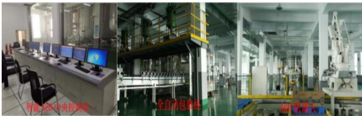
生产过程采用SMB、ABB、DDU、球扫系统，实现油品的自动输送、泵自动测控和油品的自动调和，同时还采用国内较先进的脉冲搅拌技术，实现基础油的边输送边混合，大大提高基础油在生产过程中的稳定
