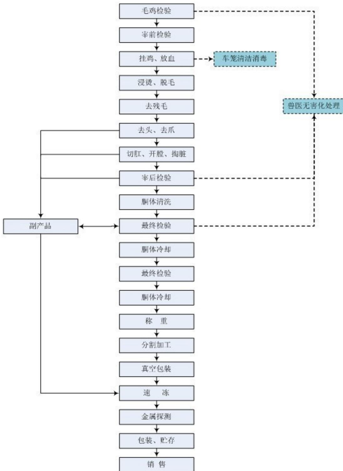
肉鸡屠宰及加工业务由子公司民和食品经营，拥有世界领先的荷兰斯托克和荷兰梅恩肉鸡屠宰加工生产线，采用西方先进的自动放血技术，防止了放血时的污染，同时达到最佳放血效果。宰杀掏脏采用全自动的方式，设备配有高压清洗系统，
