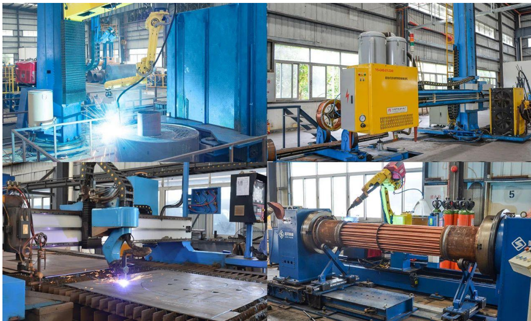
图 4：自动化机器人锅炉生产线
