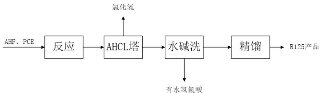
主要原料为 PCE 和 AHF，通过反应、水碱洗、精馏等工序制得 R125 产品。R125 主要用作氟致冷剂的混配工质。
