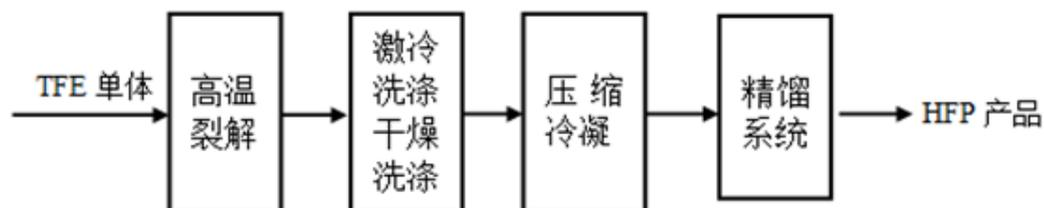
以四氟乙烯作为主要原料经高温裂解、除酸、干燥、压缩、精馏等工序制得 HFP 产品。主要用作含氟精细化工产品、药物中间体、灭火剂等。
