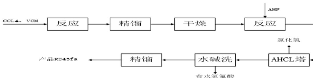
主要原料四氯化碳、氯乙烯、AHF，通过反应、精馏、干燥、水碱洗等工序制得 HFC-245fa 产品。HFC-245fa 主要用作发泡剂、致冷剂、清洗剂、气溶胶推进剂等
