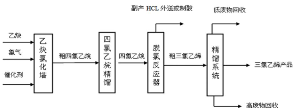
通过原料乙炔和氯气制得四氯乙烯，或者直接外购四氯乙烯，进行脱氯工序，再经过精馏制得三氯乙烯产品。三氯乙烯主要用作溶剂、清洗剂、氟化工的主要基础原料等。
