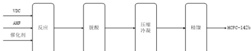
主要原料 VDC、AHF 等,通过反应、脱酸、冷凝、精馏等工序制得 HCFC-142b 产品。HCFC-142b 主要用于生产 VDF。
