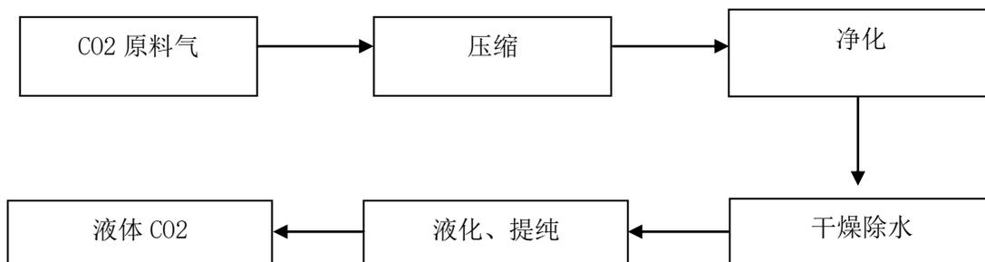
二氧化碳原料气经压缩、净化、干燥、液化、提纯制得二氧化碳产品。二氧化碳主要用于制碱工业、制糖工业、焊接、人工降雨等。
