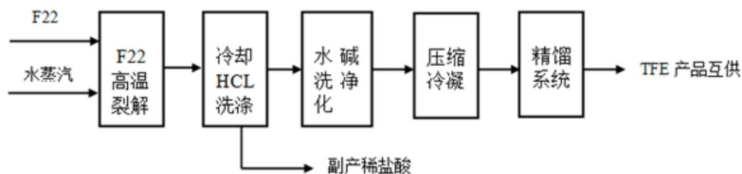
F22 通过高温裂解，水洗、碱洗、冷凝、精馏等工序，生产 TFE 产品。TFE 系 PTFE 的原料。
