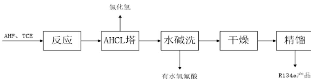
以 AHF 和三氯乙烯为原料，采用气相氟化法生产 HFC-134a 产品。HFC-134a 主要用作氟致冷剂。
