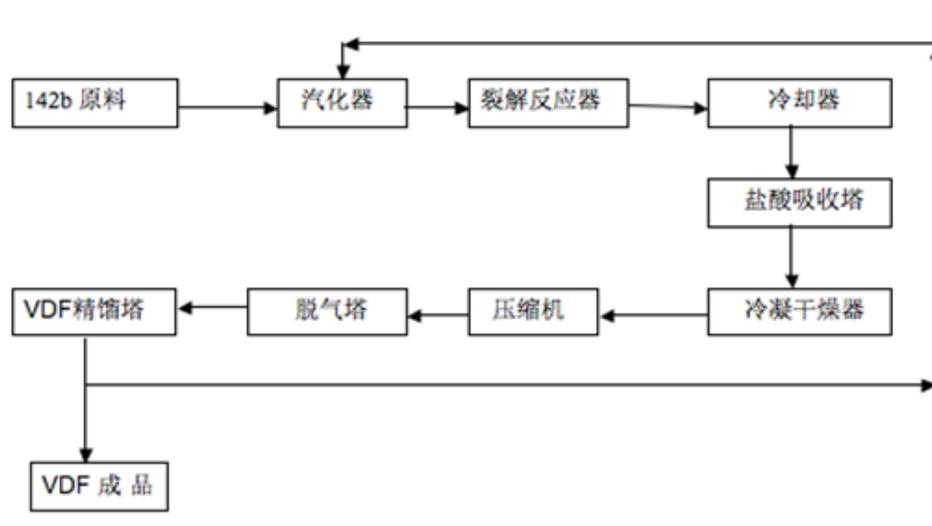
F142b 通过裂解,冷却、冷凝、干燥、精馏等工序,制得 VDF 单体。VDF 主要用于生产 PVDF。
