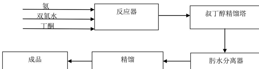
氨、双氧水和丁酮肟原料气经反应、精馏、分离、精馏制得丁酮肟产品。丁酮肟主要用于醇酸树脂涂料及环氧树脂涂料的防结皮剂、有机硅固化剂、仪表油抗氧以及作为锅炉给水的新型除氧剂等技术中。
