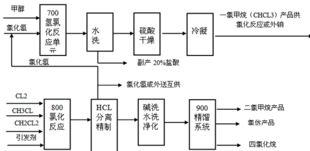
主要原料液氯和甲醇，通过氯化反应、水碱洗、精馏、氯化氢回用、干燥等工序制得甲烷氯化物产品。甲烷氯化物系氟致冷剂主要的基础原料。
