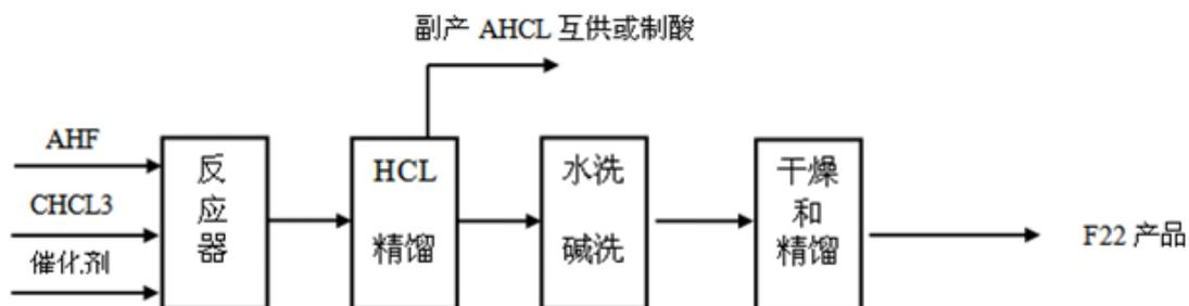
主要原料：无水氢氟酸与氯仿，在催化剂作用下，通过反应、水碱洗、精馏等工序制得 R22 产品。R22 主要用作致冷剂和氟化工下游原料。
