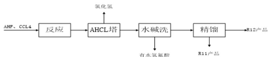
主要原料四氯化碳、无水氢氟酸，通过反应、水碱洗、精馏等工序制得 R11/12 产品。中国 1999 年 7 月份开始执行国家配额生产制度，2007 年已停止了 R12 致冷剂的生产、以及在新制冷空调设备上的初装。本公司现是我国唯一保留生产 F11/F12 权利的装置，但产量受到严格控制。
