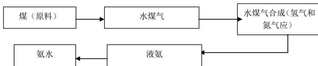
原料煤加压气化制水煤气，水煤气经过合成（氮气和氢气）得到液氨产品，气氨水吸收制得氨水。液氨是化肥、化工、医药的重要原料，氨水主要用于化肥。
