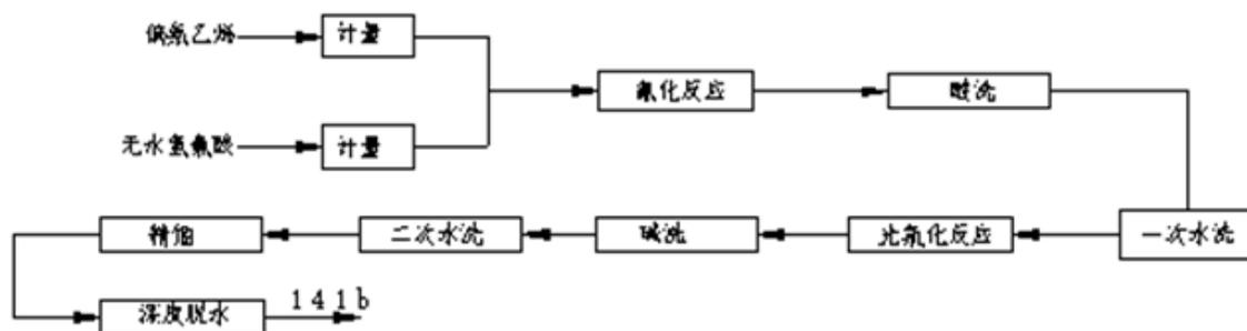
原料 VDC 和 AHF 反应，通过酸洗、碱洗、光氯化反应、精馏等工序制得 HCFC-141b 产品。
