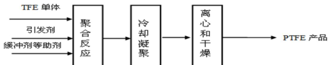
TFE 单体在引发剂存在的情况下，通过本体聚合，离心、干燥等工序制得 PTFE 产品。PTFE 主要用作工程塑料，应用于性能要求较高的耐腐蚀的管道、容器、泵、阀、无线电器材等。
