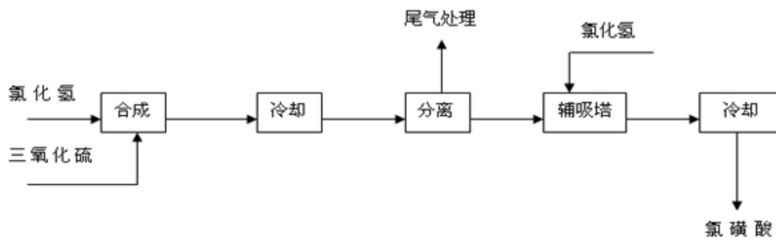
通过氯化氢和三氧化硫合成反应，经冷却、分离等工序，制得氯磺酸产品。氯磺酸系基础化工原料。
