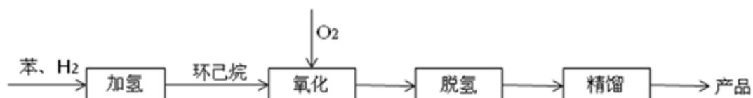
主要原料苯和氢气，采用环己烷氧化法工艺，通过氧化、脱氢、精馏等工序制得环己酮产品。环己酮主要用作有机合成原料和溶剂。
