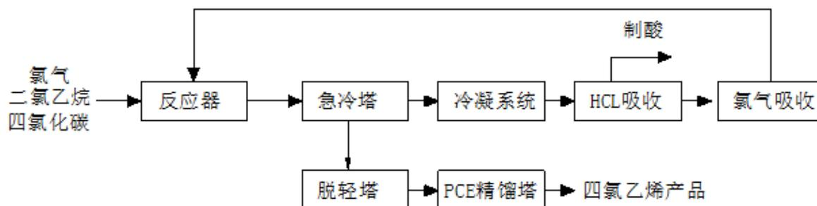
通过原料氯气、二氯乙烷、四氯化碳等经反应、冷凝、精馏等工序制得四氯乙烯产品。四氯乙烯主要用于脂肪类萃取剂、灭火剂和烟幕剂等，还可用于合成含氟有机化合物等。
