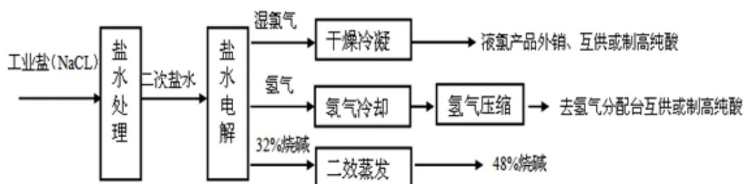
工业盐通过净化处理后，进行电解等工序，制得烧碱和氯气，同时产出氢气。烧碱和液氯系基础化工原料，广泛应用于石油化工、化纤、印染等行业。
