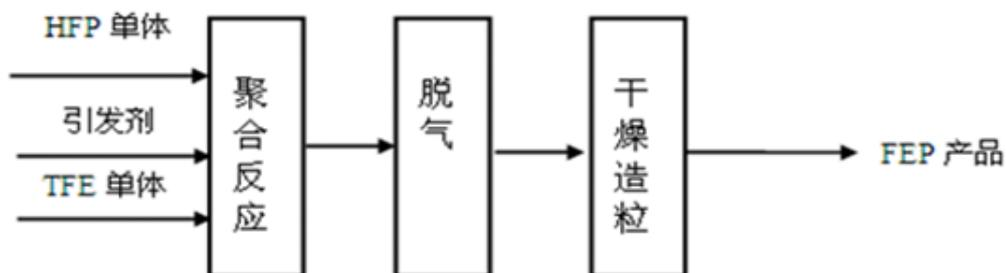
主要原料 HFP、TFE 等，通过聚合反应，经干燥、造粒等工序制得 FEP 产品。主要用于制作电子绝缘零件、电线绝缘层、化工用泵、阀的耐腐蚀衬里等。
