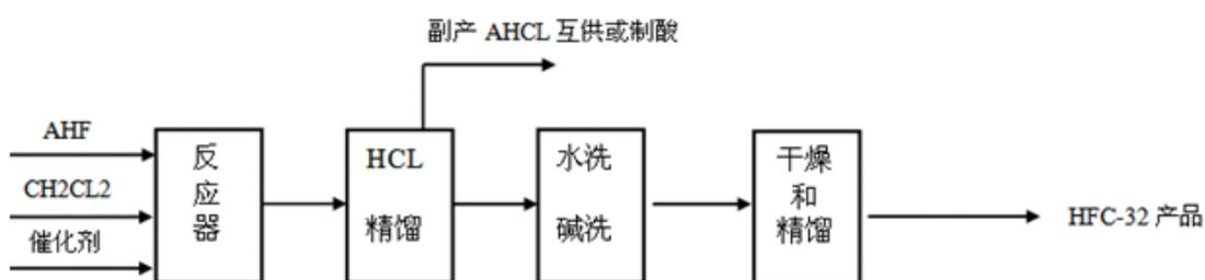
主要原料 AHF 和二氯甲烷，在催化剂存在的条件下，通过反应、精馏、水碱洗、干燥、精馏等工序制得 R32 产品，技术处于国内先进水平。R32 主要用作氟致冷剂混配工质。
