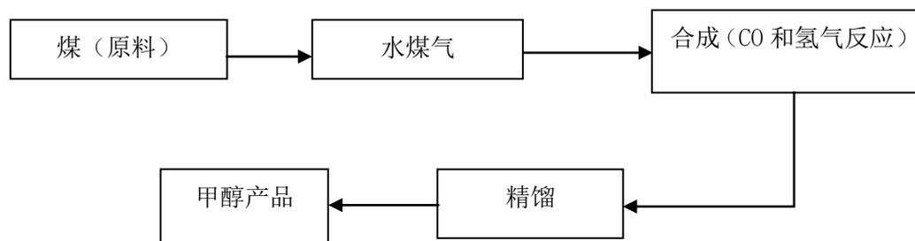
原料煤加压气化制水煤气，水煤气经过合成 (CO 和氢气) 得到甲醇粗品，经精馏制得甲醇产品。甲醇是基础有机化工原料和优质燃料。
