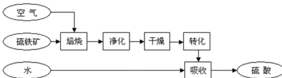
主要原料硫铁矿，采用的一转一吸矿制硫酸的工艺，制得硫酸产品。硫酸系基础化工原料。
