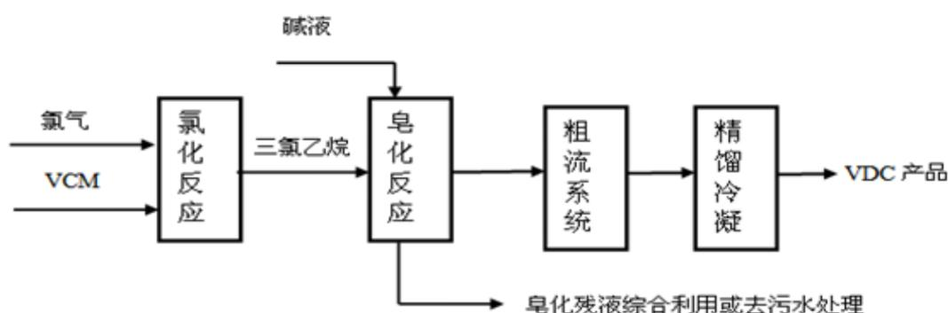
VCM 和氯气经过氯化反应，制得三氯乙烷，三氯乙烷经皂化反应、精馏等工序制得 VDC 产品。VDC 主要用作生产 PVDC、F141b 的原料。
