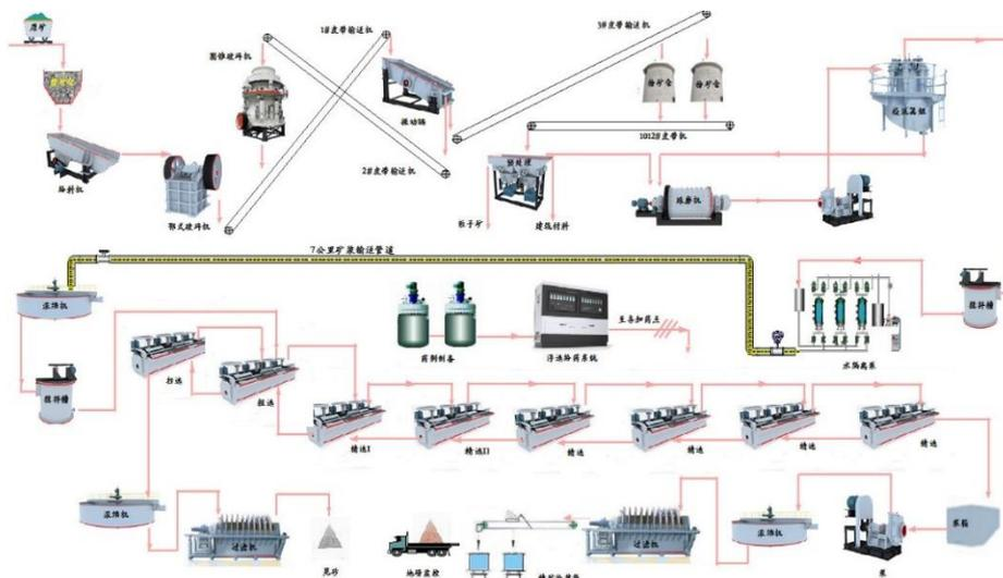
图 3：萤石选矿工艺原则流程图
