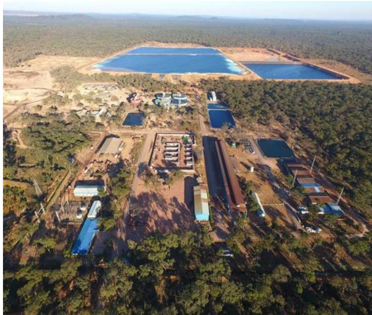
马本德湿法冶炼厂是标的公司在刚果（金）第二个建成投产的项目，2013年4月开始建设，2014年3月正式投产。2019年开始，马本德湿法冶炼厂改扩建项目正式启动，该工厂的阴极铜产能将提升至4.5万吨/年，该改扩建项目计划于2020年上半年完成。
