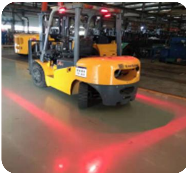
图 对在用叉车安装红外线警示灯
