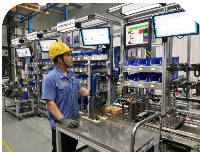
图 阀孔直线度在线检测，自动记录检测结果并进行统计过程控制
