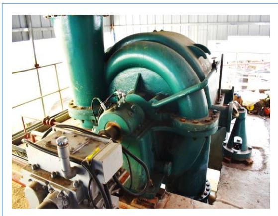
公司自主开发的主要应用于造纸行业的“多级透平真空压缩机”，首台套(型号:TP750—41)产品已制作完成，已投入使用。
