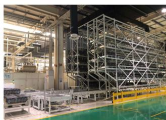
缸体缸盖立库及输送系统
