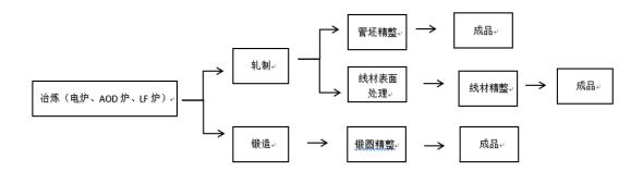
上述工艺流程显示,锻造加工系永兴合金主要的生产工艺,为其生产流程中必不可少的部分,快锻项目出售之前均采用委托永兴材料加工的方式开展生产。由于高端装备制造领域和军工领域需要认证一贯制,永兴合金及其母公司久立特材亟需自有锻造生产线以满足产品相应领域认证的需求。
