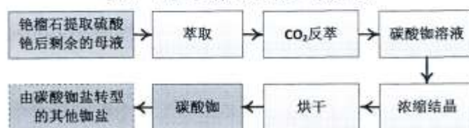
图 7 铷盐主要产品制备工艺流程图
