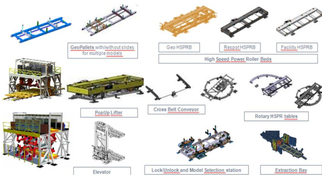
图 6：智慧物流系统应用场景：汽车生产流水线的物流运输系统
