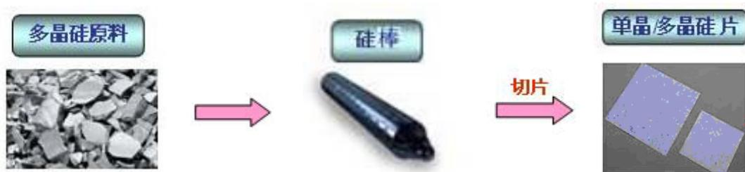
太阳能级单晶硅片的主要生产工艺流程如下：
