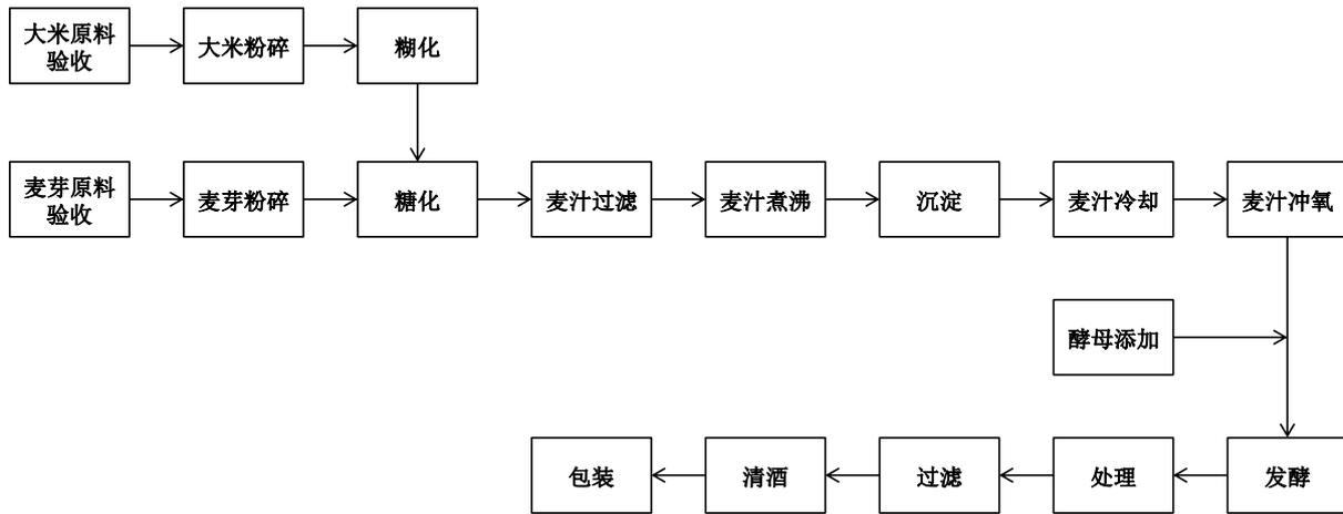
熟啤酒的生产主要包括大米和麦芽的粉碎、糊化、糖化、麦汁过滤、麦汁煮沸、沉淀、冷却、冲氧、发酵、过滤等流程。
