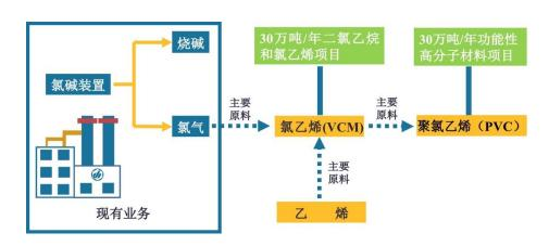
上述募投新增氯乙烯(VCM)产品将以乙烯、氯气为主要原材料,采用平衡氧氯化法生产工艺进行生产,系在申请人现有氯碱生产装置上进行的产业链延伸,主要下游为聚氯乙烯(PVC);聚氯乙烯(PVC)以氯乙烯(VCM)为主要原材料,采用悬浮聚合工艺进行生产,主要下游为管材、型材等建筑材料行业,上述新增业务与实际控制人所控制其他企业的主营业务之间存在较大差异,不存在代替性、竞争性及利益冲突。其中,申请人实际控制人控制其他企业中,中国三江化工(2198.HK)生产的聚丙烯与聚氯乙烯(PVC)归属塑料制品,但因自身特性有别,生产所需原材料、生产工艺以及下游需求差异明显,不存在明显代替性、竞争性及利益冲突。具体如下:
