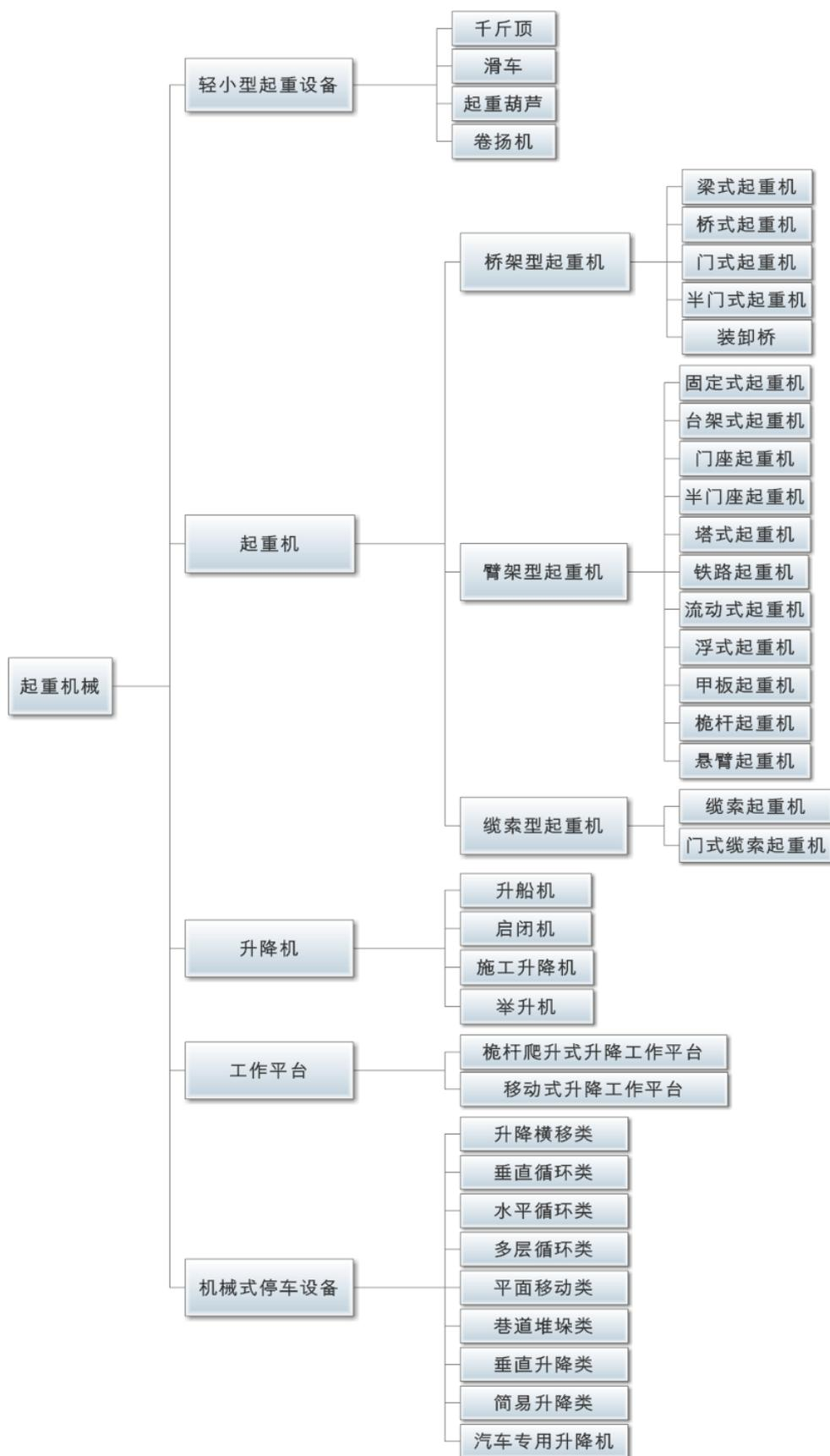
公司主要产品欧式起重机属于桥架型起重机中的桥、门式起重机范畴，电动
