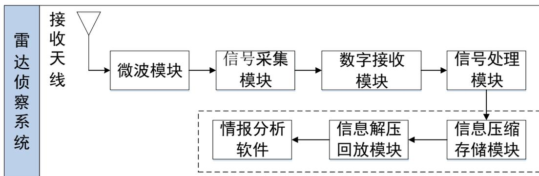
电子侦察系统包括实时处理系统和离线处理系统。电子侦察实时处理系统接收天线截获敌方雷达辐射的电磁信号后，微波模块将高频的电磁信号转化为设备可处理的中频或基带信号；信号采集模块对输入的模拟信号进行模数转化、数字采集、量化，转化为数字信号；数字接收模块完成对雷达脉冲信号的分析 and 处理；信号处理模块完成对雷达完整信息的分析和处理。电子侦察离线处理系统，在前述各模块处理的基础上，再通过信息压缩存储模块将前述各级模块产生的信息进行压缩存储，并通过信息解压回放模块回放数据，通过信息分析软件进行离线分析，最终形成完整的雷达信息描述。
