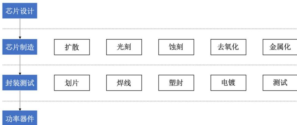
半导体功率器件产业的芯片设计、制造、封装测试等环节均具备独立生产盈利的能力。正是因为半导体生产的这一特点，行业内半导体功率器件厂商也分为了 IDM (Intergrated Device Manufacture) 模式和垂直分工两种模式，IDM 模式下厂商集芯片设计、芯片制造、芯片封装和测试等产业链多个环节于一身，便于整合内部资源，实现上下游产业协同并降低交易费用；垂直分工模式下，单独
