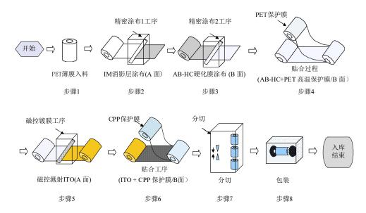
发行人所使用的核心技术包括① 湿法精密涂布技术、② 精密贴合技术、③ 真空磁控溅射镀膜技术。发行人的外协工序不涉及生产过程中的关键工序或核心技术。
