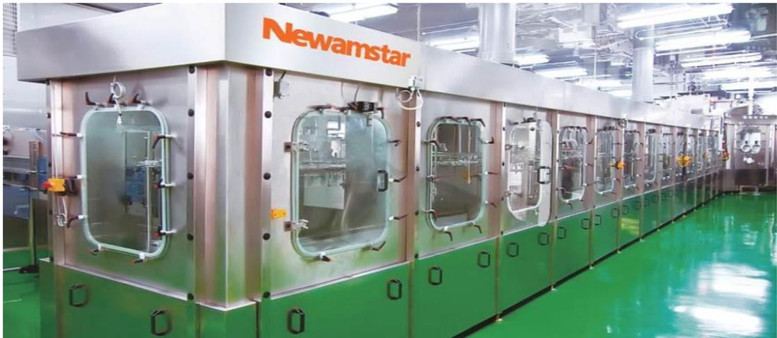
全自动高速PET瓶灌装生产线
