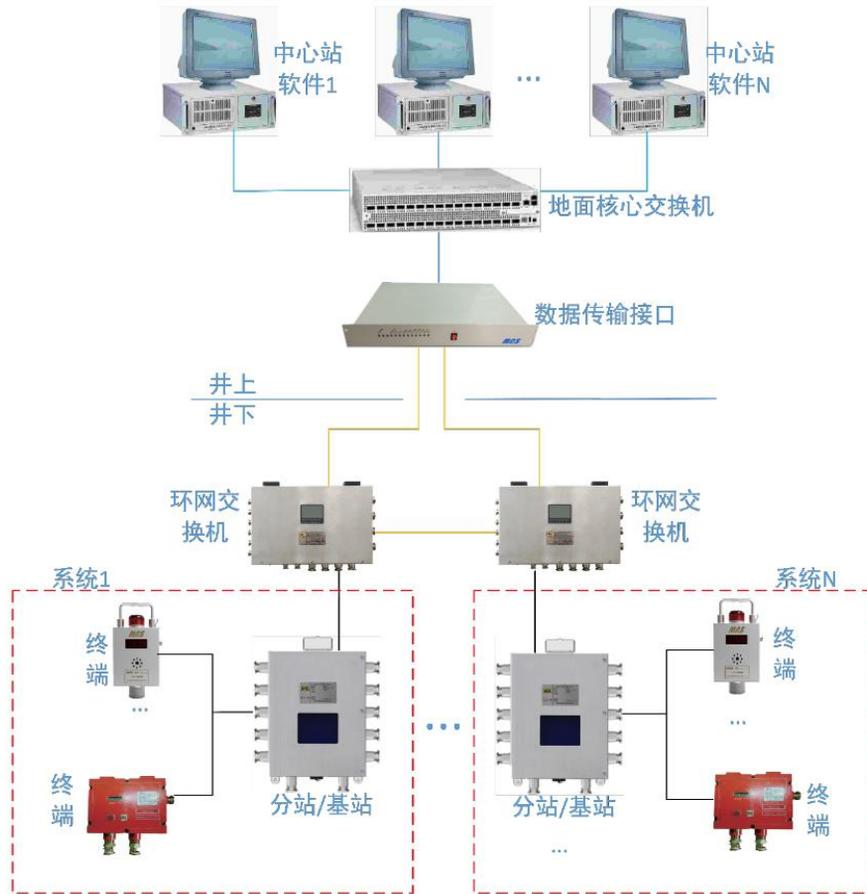
图 1 以太网+总线型网络架构
