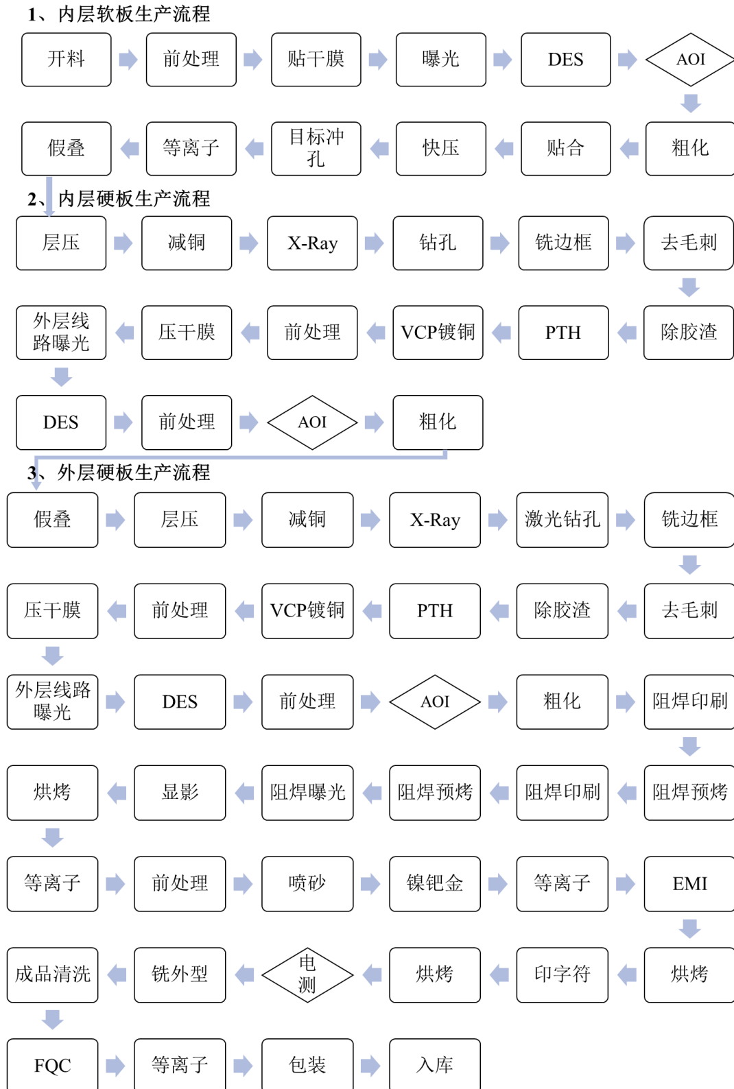
软硬结合板“片对片”生产流程图
