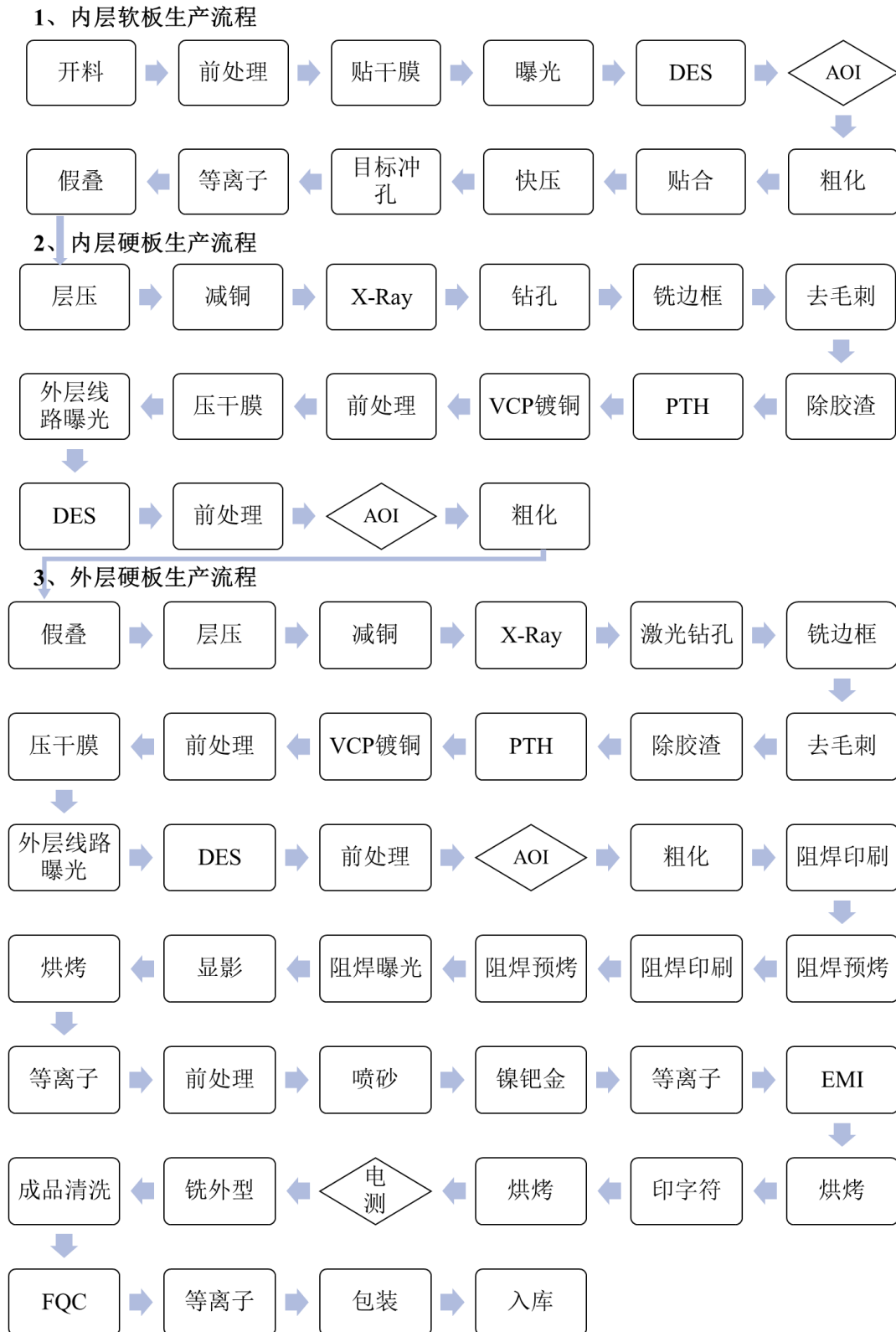
软硬结合板“片对片”生产流程图
