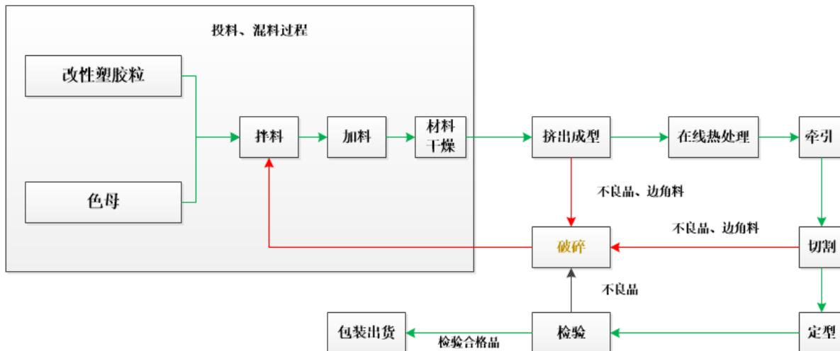
注1：绿色箭头代表对应工序合格后进入下一个加工环节，为主工艺流程；
