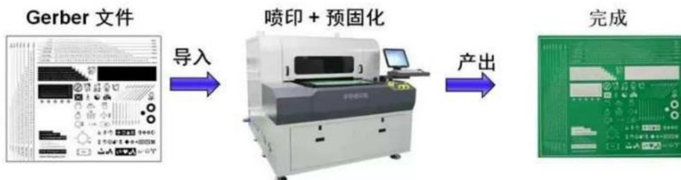
喷墨打印技术相比于传统的涂膜方式是具有颠覆 PCB 制作工艺的技术，具有诸多优点：①不需要制作网版，节省了场地与空间；②生产工序简单，提高了产能、降低了成本；③可达到更高的布线密度，具有更好的精准性，有效解决线路板胀缩、网印工艺线条不连续等问题；④减少了油墨用量，不需要使用显影液、有机溶剂等化学药剂，极大的减少了废液、废气、废渣的产生，更加环保。
