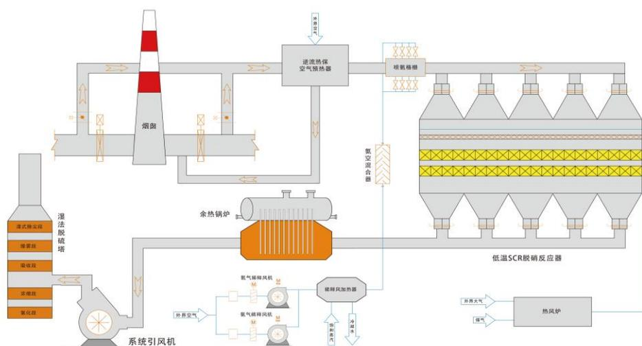
2015 年，由中冶焦耐提供技术设计、公司提供脱硝设备、北京方信提供脱硝催化剂的宝钢湛江钢铁焦化项目焦炉烟气净化装置正式投产，标志着世界首套焦炉烟气低温脱硫脱硝工业化示范装置诞生，被《世界金属导报》评选为 2015 年“世界钢铁工业十大技术要闻”之第二大要闻。该装置中的脱硝反应系统已稳定运行三年，平均脱硝效率大于 90%。
