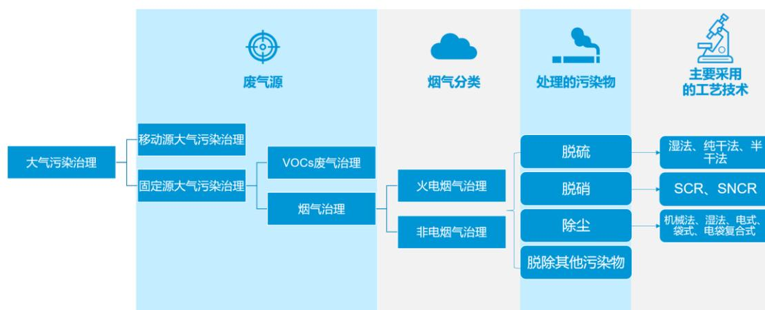
除尘是指从烟尘、粉尘等含尘气体中去除颗粒物以减少其向大气排放的技术措施。目前市场上通常采用机械式除尘、电除尘、过滤除尘、湿法除尘和新型复合除尘等五类除尘技术，其中布袋除尘（过滤除尘）、电除尘和电袋复合除尘是我国目前主流的除尘技术。
