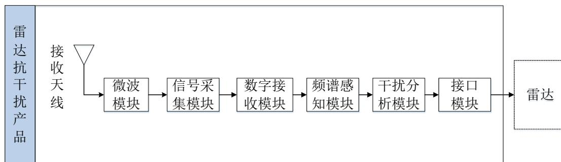
雷达抗干扰系统通过接收天线接收空间的电磁频谱信号，微波模块将高频的电磁频谱信号转化为设备可处理的中频或基带信号；信号采集模块将输入的模拟信号转化为数字信号；数字接收模块完成对各脉冲信号的分析，获取脉冲信号频率、脉宽等特征参数；频谱感知模块再依据获得的特征参数对辐射源信号进行归类和分析，形成频率、幅度等详细的频谱态势数据，判断干扰状态；由干扰分析模块优选处理针对性抗干扰措施，通过接口模块发送给雷达处理系统，辅助雷达进行干扰消除，确保雷达接收、处理功能在干扰背景下依然保持基本正常，实现对关心目标的搜索、跟踪功能。
