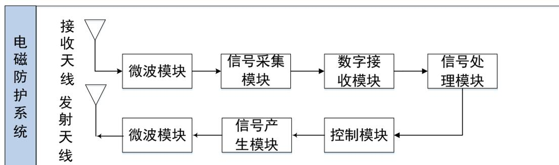
电磁防护系统接收天线接收敌方雷达信号后，微波模块将高频信号转化为设备可处理的中频或基带信号；信号采集模块将输入的模拟信号转化为数字信号；数字接收模块完成对各雷达脉冲信号的分析，获取脉冲信号频率等特征参数；信号处理模块再依据获得的特征参数对雷达脉冲信号进行归类和分析，获取被干扰雷达信号的特征参数，用于引导控制模块形成对应的干扰控制和决策信息；信号产生模块根据控制模块的控制指令及数据采集模块输出的信号，构造各种干扰信号，再由微波模块将干扰信号转换为高频信号后通过发射天线发射。
