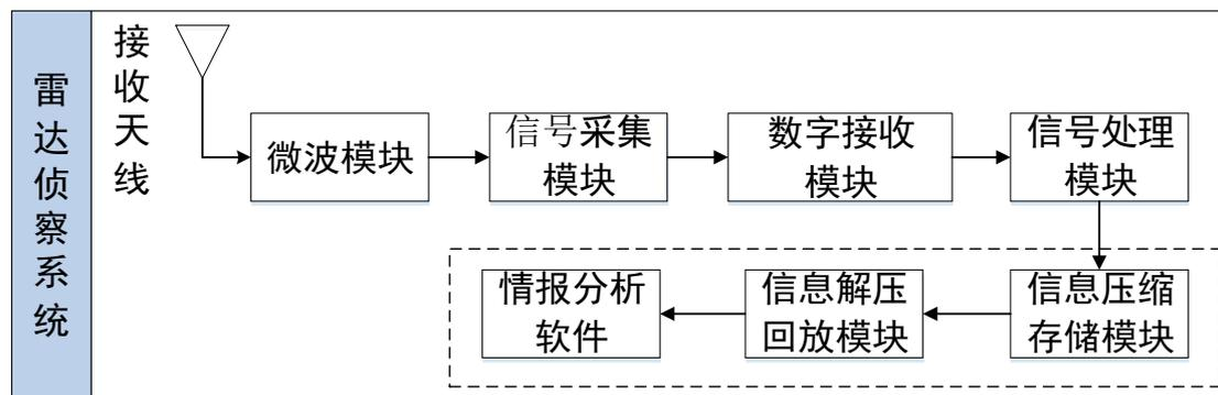
电子侦察系统包括实时处理系统和离线处理系统。电子侦察实时处理系统接收天线截获敌方雷达辐射的电磁信号后，微波模块将高频的电磁信号转化为设备可处理的中频或基带信号；信号采集模块对输入的模拟信号进行模数转化、数字采集、量化，转化为数字信号；数字接收模块完成对雷达脉冲信号的分析 and 处理；信号处理模块完成对雷达完整信息的分析和处理。电子侦察离线处理系统，在前述各模块处理的基础上，再通过信息压缩存储模块将前述各级模块产生的信息进行压缩存储，并通过信息解压回放模块回放数据，通过信息分析软件进行离线分析，最终形成完整的雷达信息描述。
