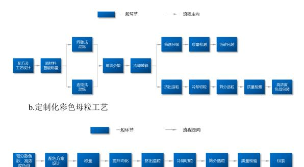
以上两种工艺是按颜色黄、橙、红、绿、蓝、特殊效果颜色等建立多条生产 线,根据不同颜料的化学结构特性,选择最优设备生产高浓度与分散色砂、色母 粒,最后再根据客户订货要求,通过智能化配色系统测色,采用高浓度预分散色 砂、色母粒,按配方搅拌均匀,挤出造粒,装袋。
