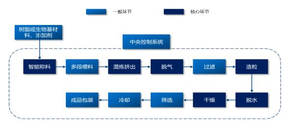
通过上述生产工艺流程图可知,黑色母粒和白色母粒主要采用连续式混炼工
