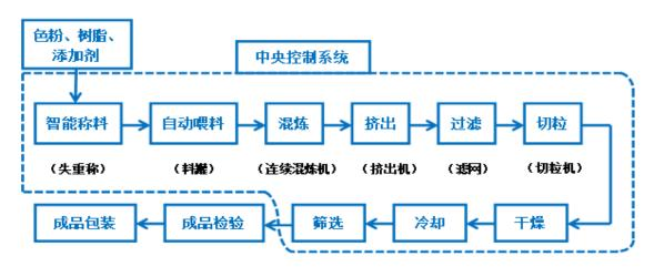
上述工艺主要以树脂为载体、添加钛白粉或者炭黑,利用连续混炼机生产白色母粒或者利用下落式密炼机/密炼机+挤出机生产黑色母粒。
