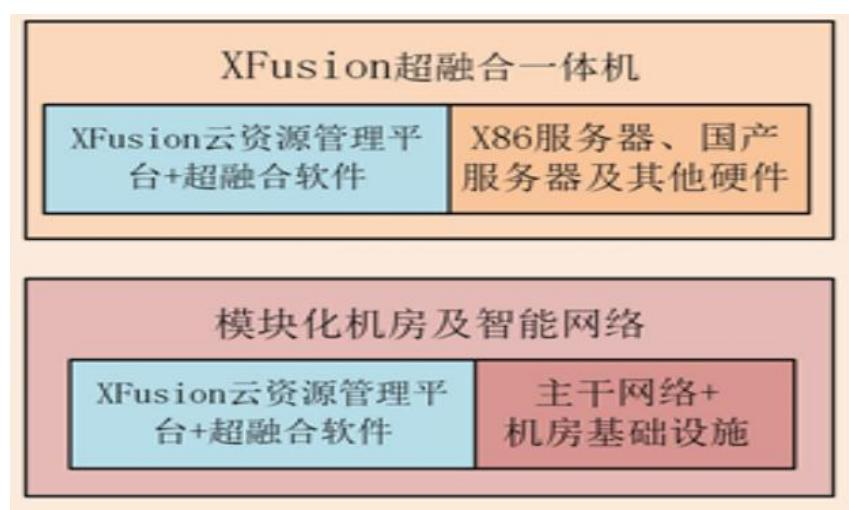
如上图所示，超融合一体机由 Xfusion 云资源管理平台、超融合软件及服务器等硬件构成，模块化机房及智能网络由 Xfusion 云资源管理平台、超融合软件及机房等基础设施构成。超融合一体机与模块化机房及智能网络的技术更新主要为软件方面的技术更新，故超融合一体机与模块化机房及智能网络的技术更新迭代周期是一致的。
