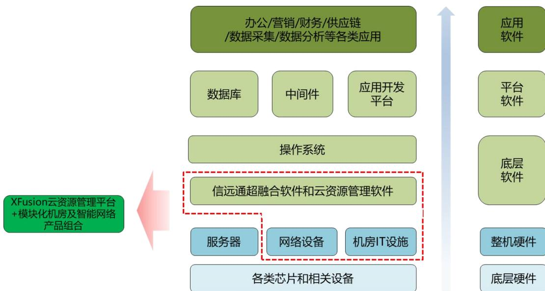
XFusion 云资源管理平台+模块化机房及智能网络产品组合的表现形态为模块化机房及智能网络即标准化机柜和各种微模块，包括网络模块、制冷模块、电源模块、环境监控传感器等，以及相应线缆。XFusion 云资源管理平台为预装好的服务器，以及相应的线缆配件。标的公司根据客户需求配置将相应产品发货到客户指定现场，标的公司实施人员到现场后，能够快速实施，快速搭建云数据中心的微模块机房环境。
