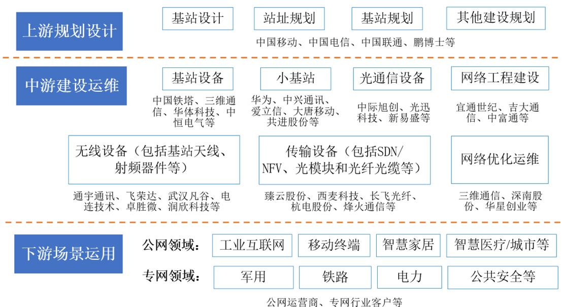
①上游规划设计环节：根据工信部《关于2019年推进电信基础设施共建共享的实施意见》，5G基站规划原则为：规划先行、需求引领、市场化合作。该环节主要系三大运营商等公司集约利用现有基站站址和路灯杆、监控杆等公用设施，进行基站部署设计，储备5G站址资源。
