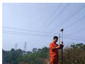
RTK 在电力勘测及塔基断面中的应用
