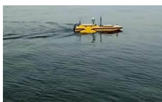
无人船测量系统（无人船载体+RTK+测深仪）
