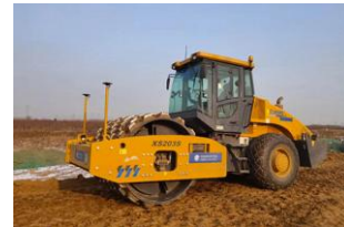
智能压实+无人驾驶系统 助力雄安新区建设
