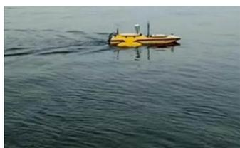
无人船测量系统（无人船载体+RTK+测深仪）
