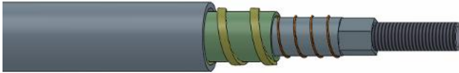
DBS 玻璃臭氧放电管示意图
