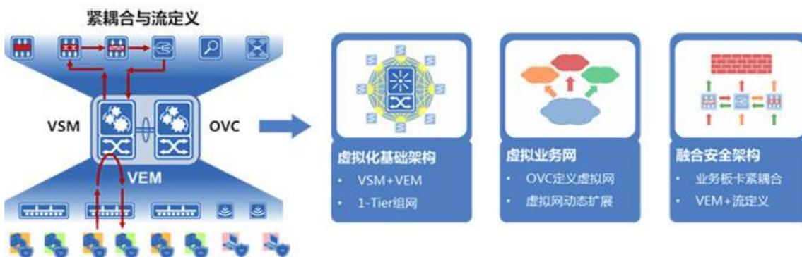
1) VSM (Virtual Switching Matrix) 虚拟交换矩阵: L2~7 层 N: 1 虚拟化技术, 可以将多台设备虚拟为一台逻辑设备。VSM 不仅实现了网络资源的虚拟化,
