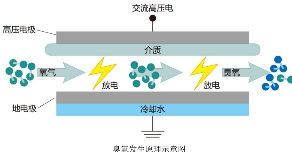
介质阻挡放电技术易于制造单机臭氧产量高的设备，技术进步快，相对能耗较低，能够实现臭氧的工业应用，是目前市场占有率最高、应用最广的技术。
