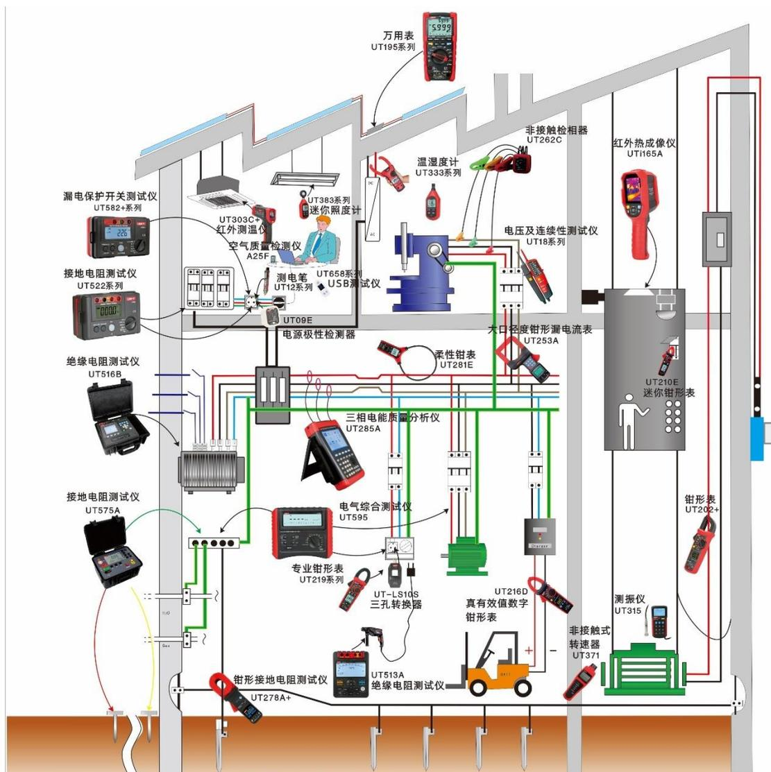
从电力配网到用电用户的电力布线、分配、安装等过程，均可使用公司产品进行检查，主要包括：在电力配网和用户用电过程，使用绝缘电阻测试仪来做线路变压器的绝缘性能检测；使用三相电能质量分析仪对电力稳定性进行定期检测或长期监控；通过检测漏电保护开关来保障用电安全；使用红外热成像仪来检测线路运行状态等。
