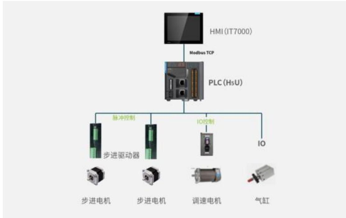
该 SMT（贴片组装）产线辅助设备电控产品配置由一台汇川控制的 IT7000 系列 HMI，一台汇川控制的 H5U 系列 PLC，和其他公司的步进驱动器、步进电机、调速电机和气缸等组成。
