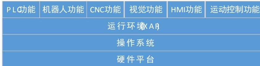
目前,上市公司体系下控制层产品分别处于不同的控制层产品平台,各个控制层产品平台结构图如下:
