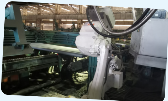
兴澄特钢一轧钢机器人高温圆钢标识系统能够替代坯料岗位人员高温贴标作业，消除烫伤风险
