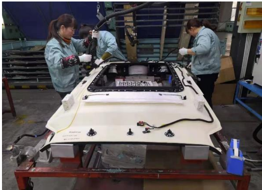
顶衬总成装配过程
