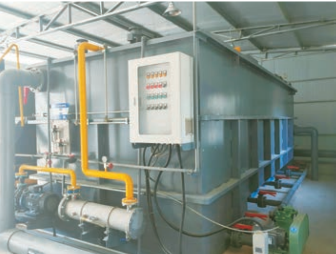
揭阳工厂污水深度处理 MST-EMB 超高速离子气浮
