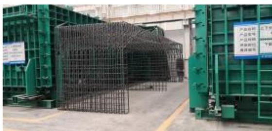
智能化地下综合管廊网片焊接生产线解决了目前焊接管廊网片人工劳动强度大，效率低，焊点经常出现漏焊或者强度不够、烟尘大等问题，该钢筋生产流水线，可将管廊用钢筋自动剪切、弯曲、对焊、并且将管廊钢筋设计为网片形式，管廊网片焊接和弯曲工艺融合一体，实现对网片焊接，及对成型网片弯曲角度的功能，无需更换设备和工艺，工人只需组装即可，大大降低了工人的劳动强度，每个焊点强度一致可控。此智能化生产线，技术水平较高，设备自动化程度达到业内较先进水平，为该行业的未来提供有利支撑。
