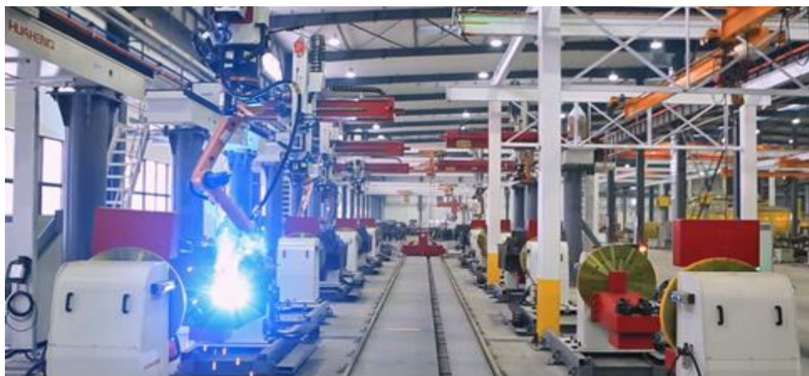
车架焊接自动化流水线
