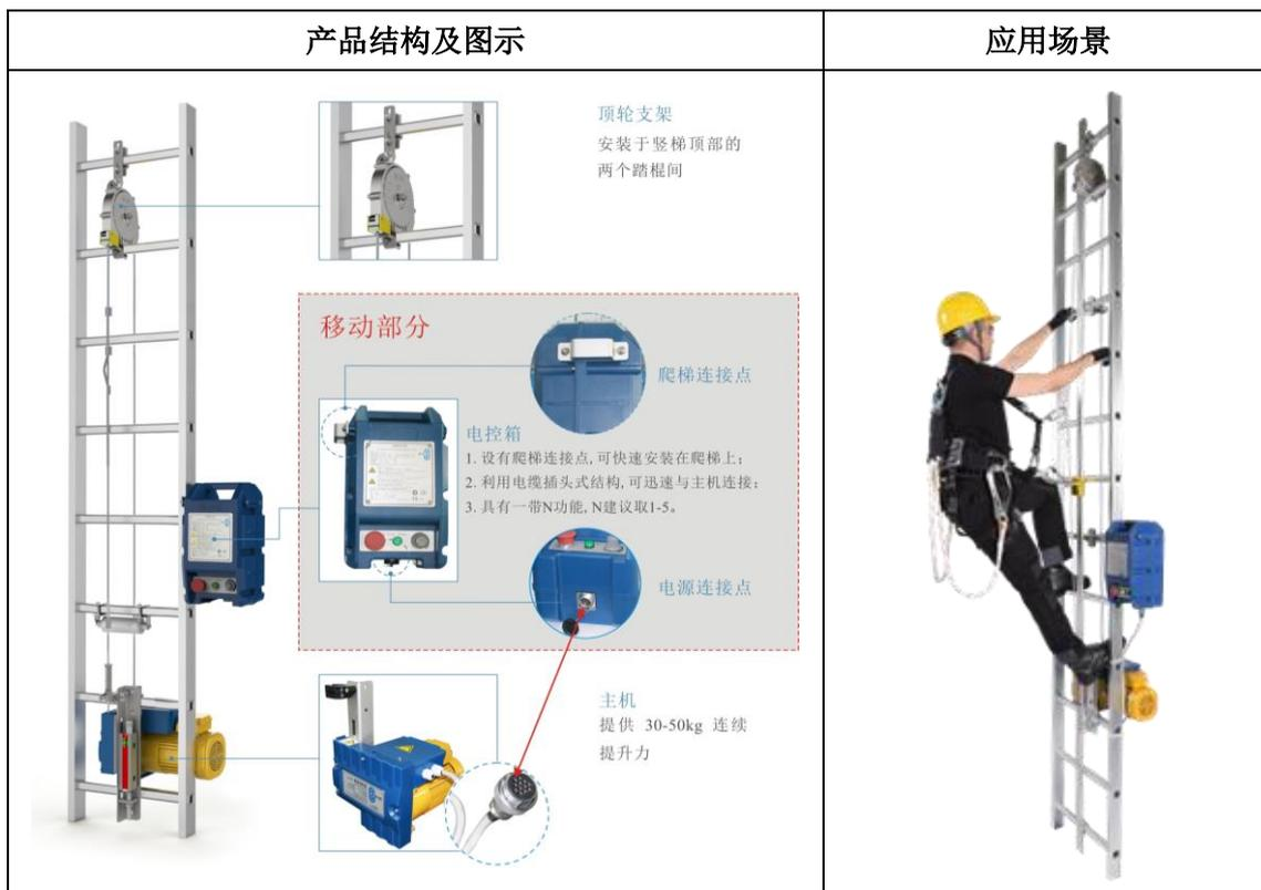
助爬器无需对现有构筑物进行改造即可安装，安装和操作方便，易于维护。助爬器包括固定部分和移动部分，固定部分安装固定在风机塔筒内的爬梯上，主要包括顶部支架、牵引钢丝绳、主机等；移动部分主要为电控系统，可由作业人员携带，在使用前安装在爬梯上，并与固定部分配套使用。
