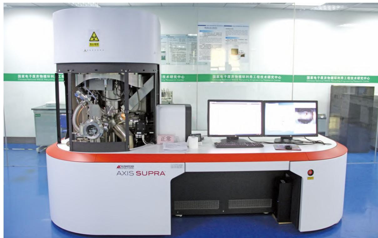
X射线光电子能谱仪
