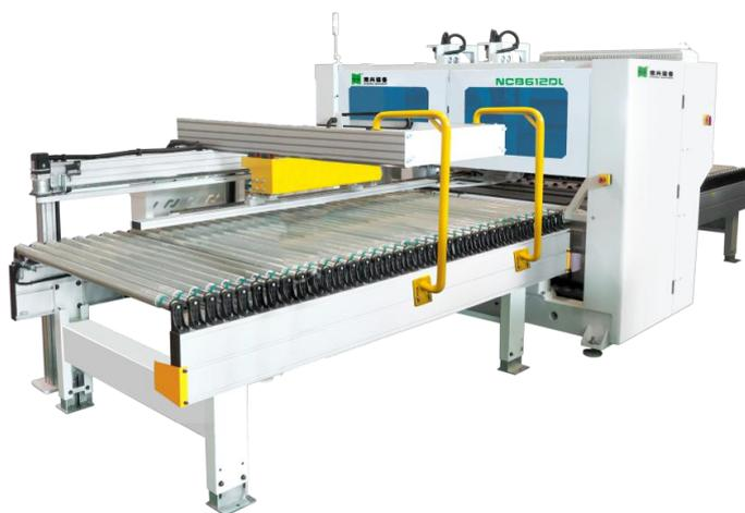
六面数控钻孔中心连线
