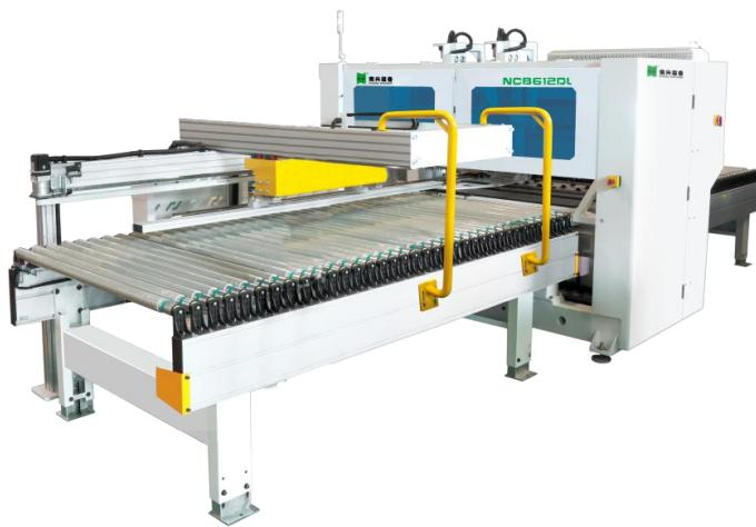
六面数控钻孔中心连线
