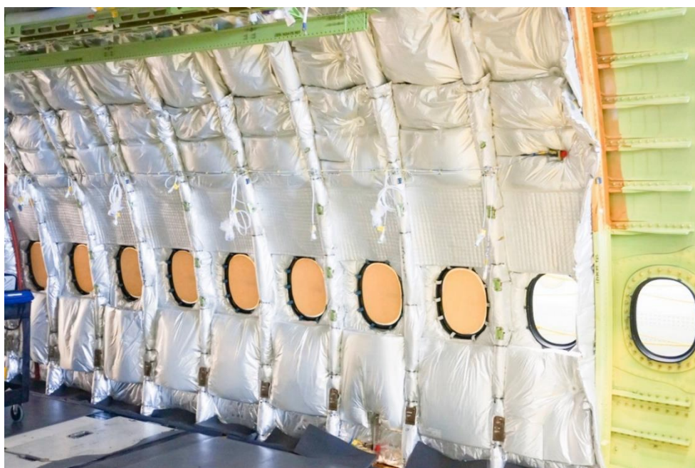
（图 装配隔音隔热毯的机舱）
