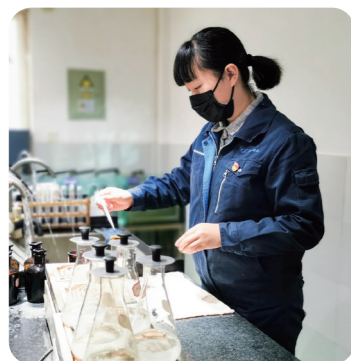
水厂运行值班员开展水质感官指标检测
