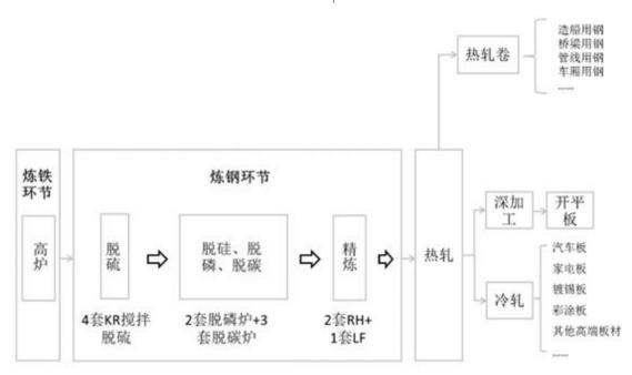
京唐公司生产产品的工艺分为炼铁环节、炼钢环节、热轧、冷轧等,具体如下:
